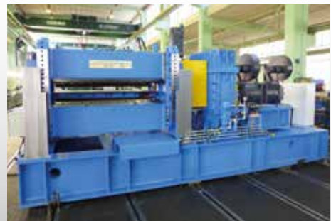
Querteilanlage, Fa. Ungerer Systeme GmbH
